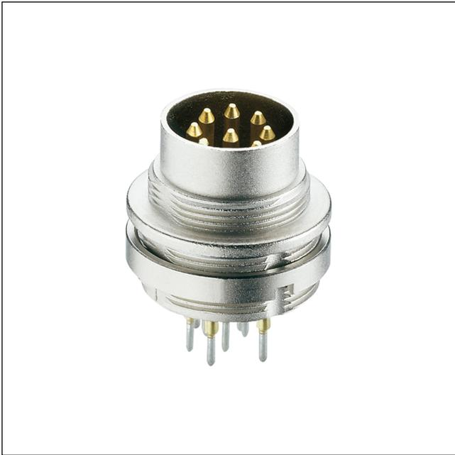
Einbaustecker nach AISG-Spezifikation und IEC 61076-2-106, IP68, mit Schraubverschluss, für Leiterplatten, für Frontmontage
