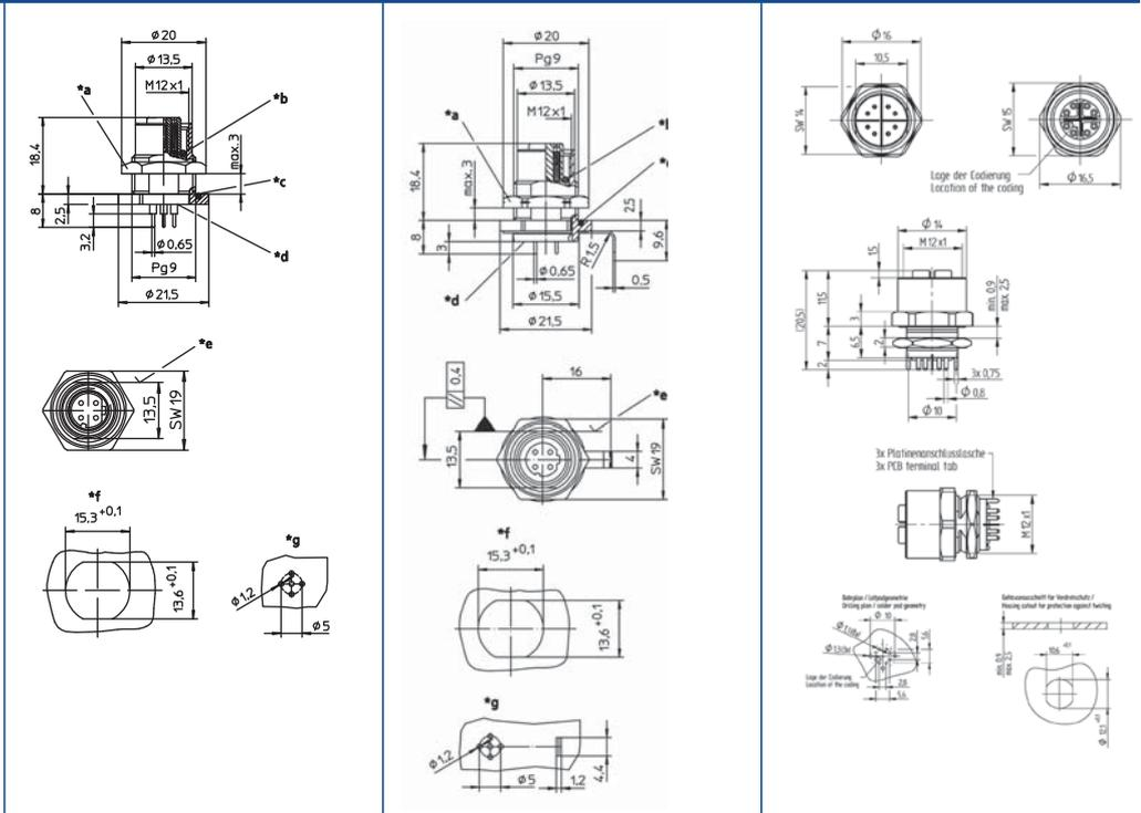
\*a = Mutter • \*b = O-Ring • \*c = O-Ring • \*d = Leiteranschlussbereich vergossen • \*e = Verdrehschutz • \*f = Einbauöffnung für Verdrehschutz • \*g = Lochbild in der Leiterplatte
